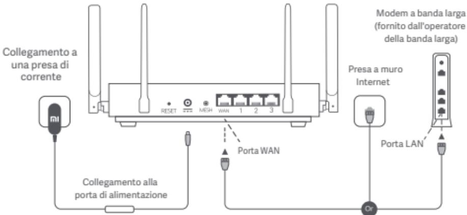
\*Il modem a banda larga è fornito dall'operatore della banda larga. Se non è disponibile, è possibile collegare il cavo di rete al router e alla presa a muro Internet o collegare direttamente il cavo di rete per interni alla porta WAN del router.
