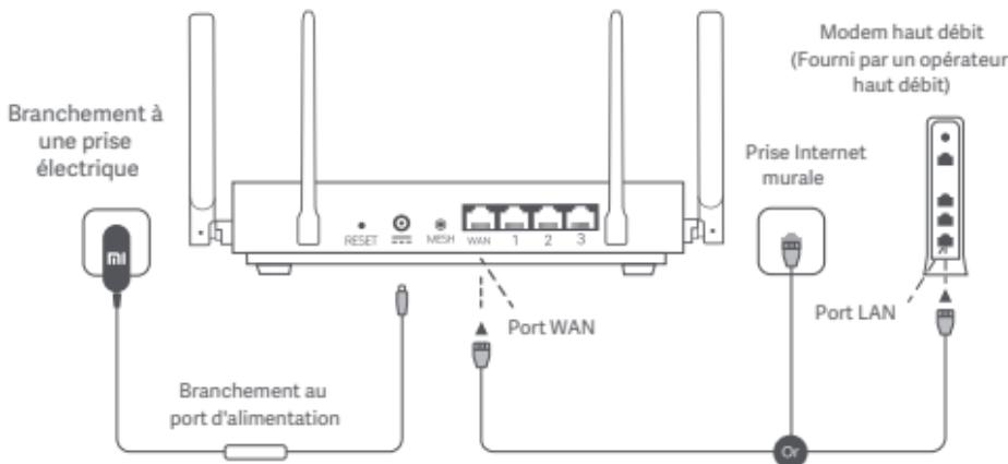
\*Le modem haut débit est fourni par l'opérateur haut débit. S'il n'est pas disponible, vous pouvez brancher le câble réseau au routeur et à la prise Internet murale, ou directement brancher le câble réseau intérieur au port WAN du routeur.
