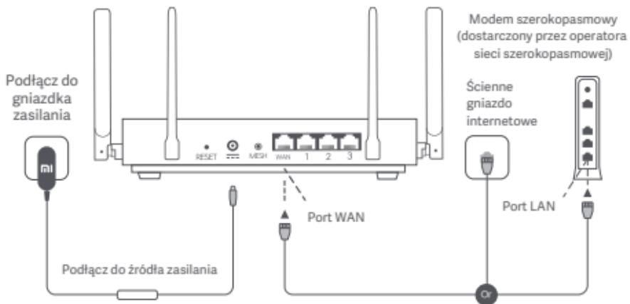
\*Modem szerokopasmowy jest dostarczany przez operatora sieci szerokopasmowej. Jeśli nie jest on dostępny, można podłączyć przewód sieciowy do routera i ściennego gniazdku internetowego lub bezpośrednio podłączyć przewód sieciowy do portu WAN routera.
