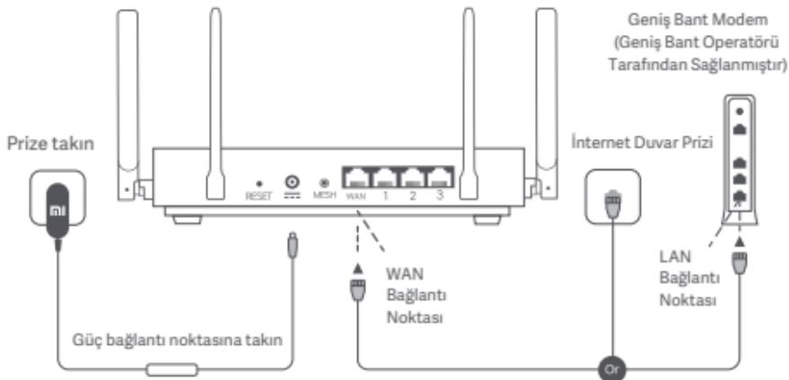
\*Geniş bant modem, geniş bant operatörü tarafından sağlanır. Geniş bant modem mevcut değilse ağ kablosunu yönlendiriciye ve internet duvar prizine takabilir veya dahili ağ kablosunu doğrudan yönlendiricinin WAN bağlantı noktasına takabilirsiniz.
