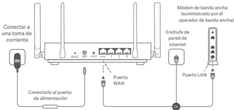
\*El operador de banda ancha suministra el módem de banda ancha. Si no estuviera disponible, puede conectar el cable de red al router y el enchufe de pared de internet. También puede conectar el cable de red interior al puerto WAN del router.
