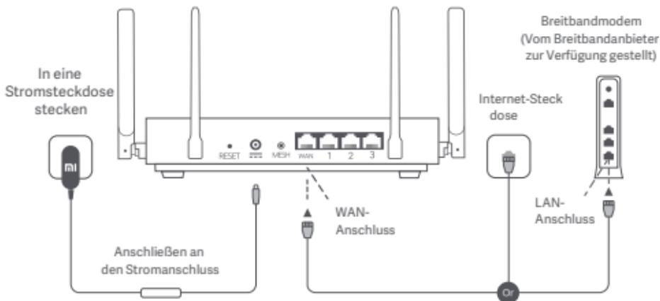
\*Das Breitbandmodem wird vom Breitbandanbieter bereitgestellt. Wenn es nicht verfügbar ist, können Sie das Netzwerkkabel mit dem Router und der Internet-Steckdose verbinden oder das Netzwerkkabel für den Innenbereich direkt mit dem WAN-Port des Routers verbinden.
