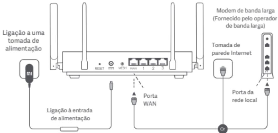
\*O modem de banda larga é fornecido pelo operador de banda larga. Caso não esteja disponível, pode ligar o cabo de rede ao router e à tomada de parede Internet, ou ligar diretamente o cabo de rede interior à porta WAN do router.
