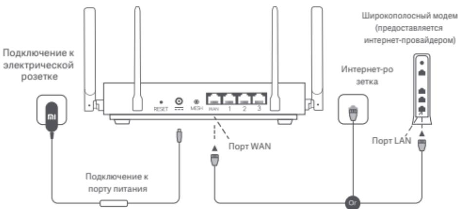
\* Широкополосный модем предоставляетяется интернет-провайдером. Если он недоступен, вы можете подключить сетевой кабель к маршрутизатору и интернет-розетке либо подсоединить кабель домашней сети к порту WAN маршрутизатора.
