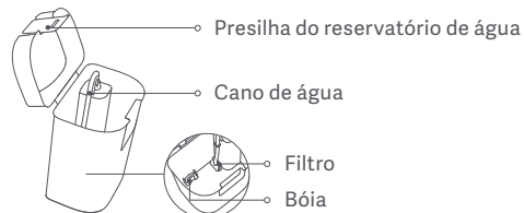
Depósito de água limpa
